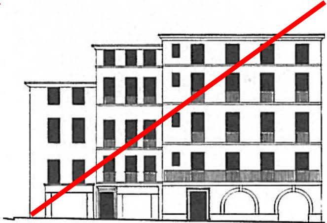
La coupure des façades entre le rez-de-chaussée et les étages nuit à la composition de façade, aux descentes de charge et à la répartition des pleins et des vides.
